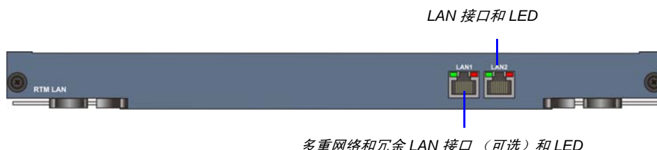
图 1-4 RMX 2000 RTM LAN 后面板布局
